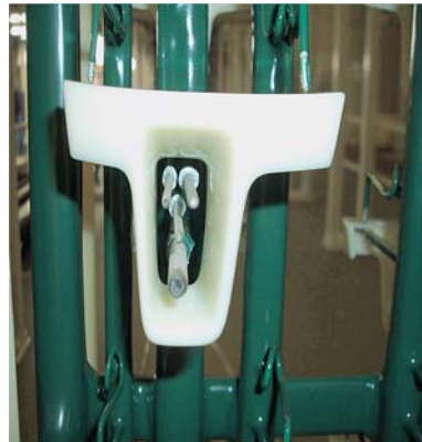
Abb. 8: Aufgesteckte Lenkradblende auf Versuchsgestell mit platinieren Innenanoden
